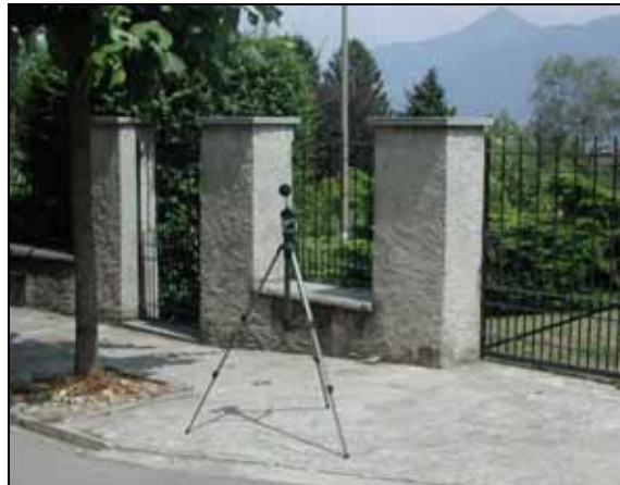
Foto 2 – Vista de fonometro posizionato su treppiede mobile
